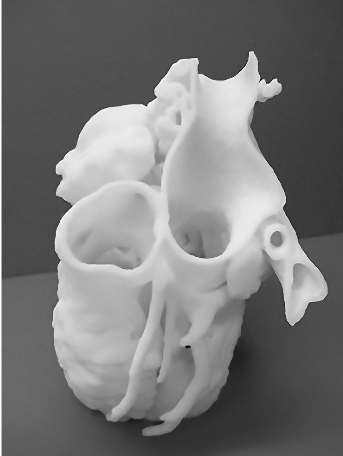
Figure 4: reproduction d'une vertèbre par reproduction 3D en PLA à partir d'un scan IRM (gauche) et impression 3D d'un coeur (bas)
